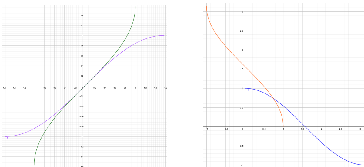
FIGURE 2 – À gauche : courbes représentatives des fonctions sinus sur [-\frac{\pi}{2}, \frac{\pi}{2}] (en violet) et arc sinus (en vert). À droite : courbes représentatives des fonctions cosinus sur [0, \pi] (en bleu) et arc cosinus (en orange).
